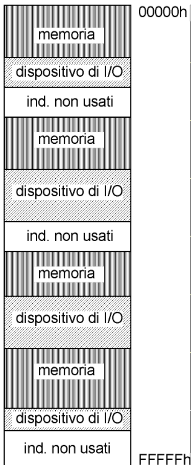
Figura 3: frammentazione della memoria per effetto dei circuiti di I/O
